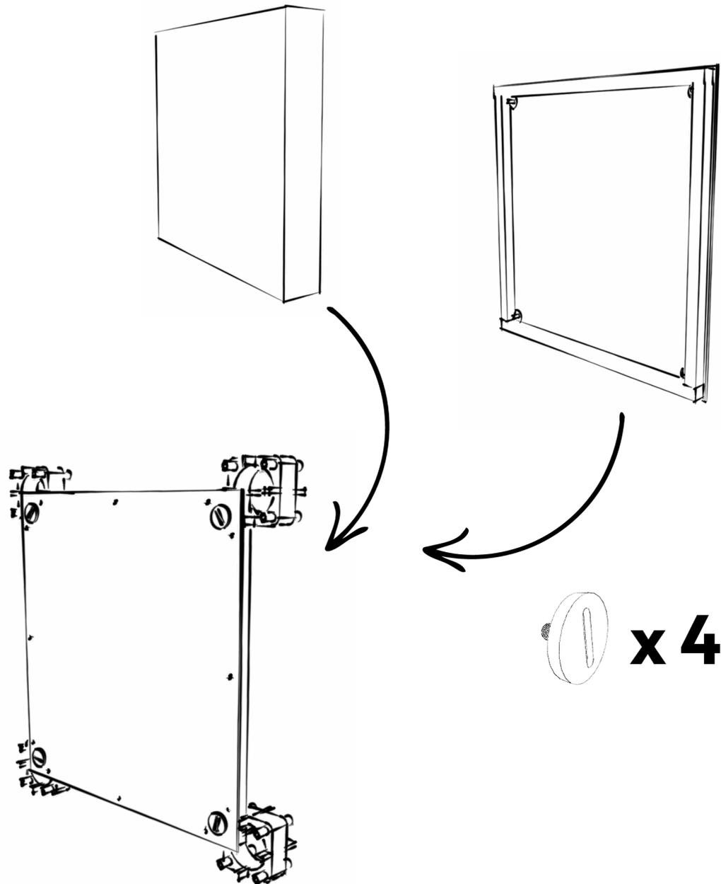
Si vous souhaitez ajouter de l'isolant, glissez le entre les deux panneaux au moment du montage.
