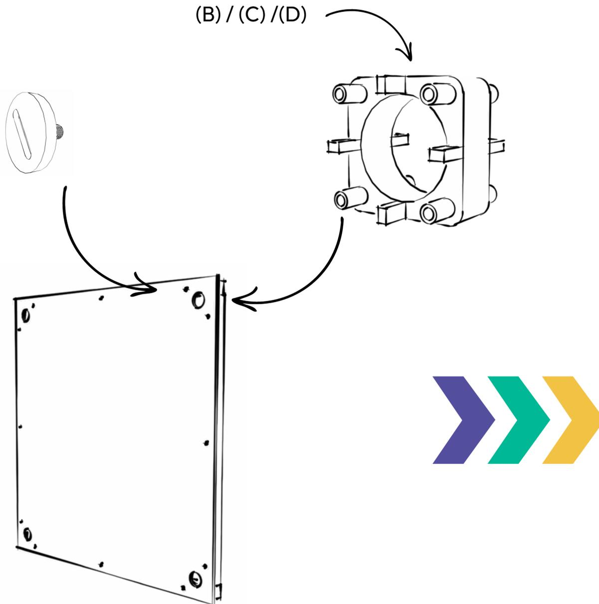
1. Insérez le tube fileté du connecteur dans les emplacements troués prévus sur le panneau.
